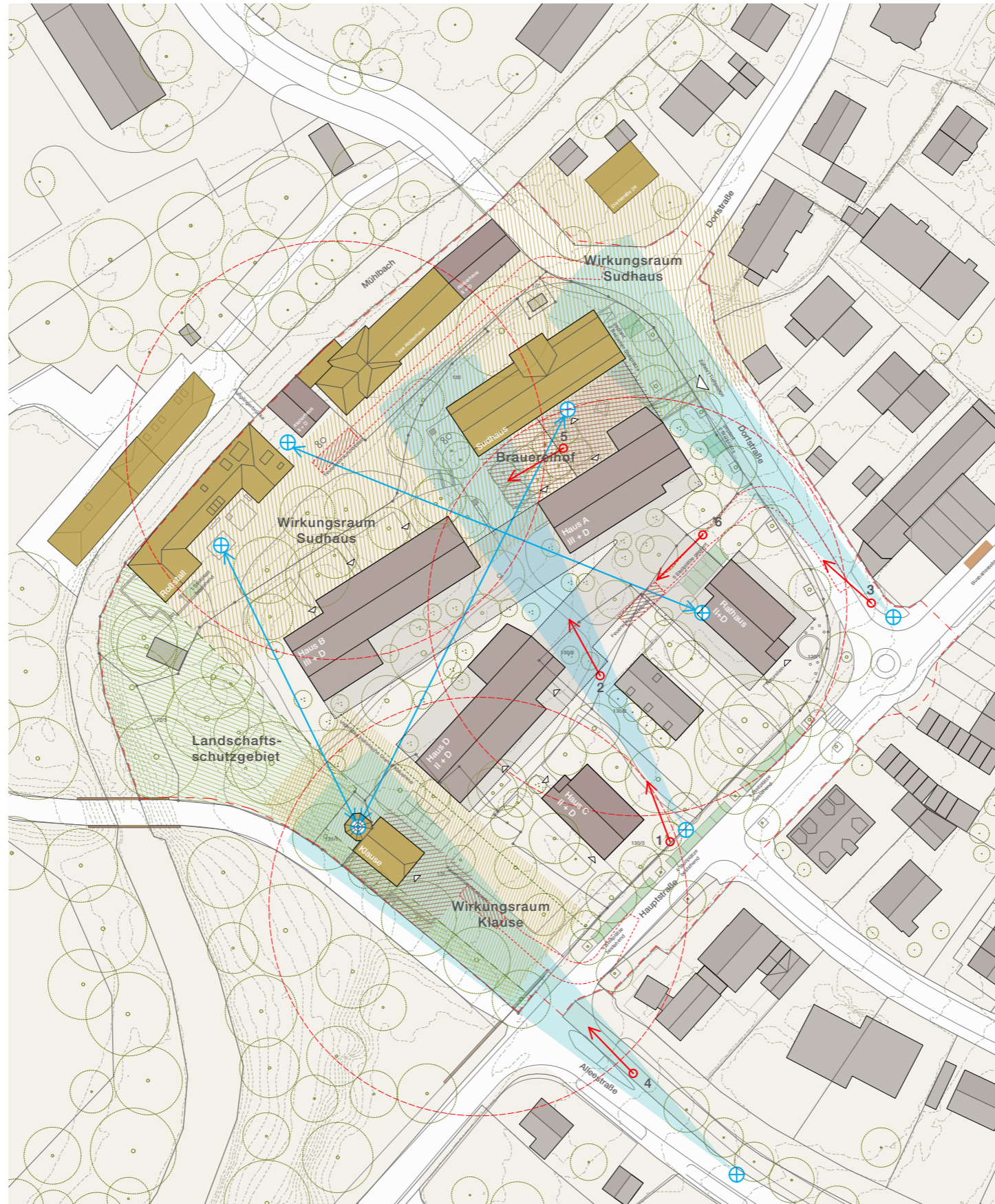
Technischer Lageplan, M 1:500 (Raumwirkung und Sichtbezüge im Denkmalensemble und Darstellung des ruhenden Verkehrs)
