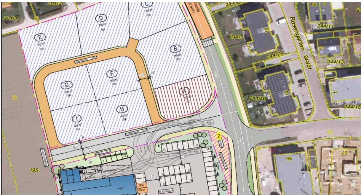
Abbildung 3: Lage und Anbindung der Erschließungsstraße, Ausschnitt aus „Lageplan Entwurf 07“, Stand 02.11.2020, Planverfasser: RATISBONA HANDELSIMMOBILIEN
